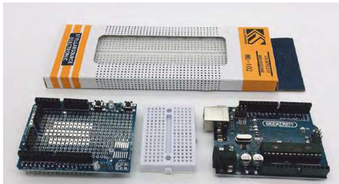
Slika 2: Slika Združljiva UNO_R3 razvojna plošča, razvojna plošča (shield) in velika prototipna plošča in majhna prototipna plošča
