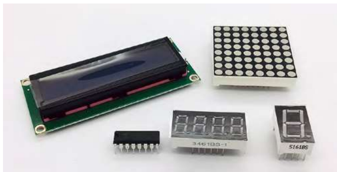
Slika 3: LCD in LED prikazovalniki z DODANIM INTEGRIRANIM VEZJEM 74HC595
